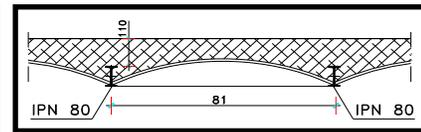
Figura 2: Sección del forjado [elaboración propia].
