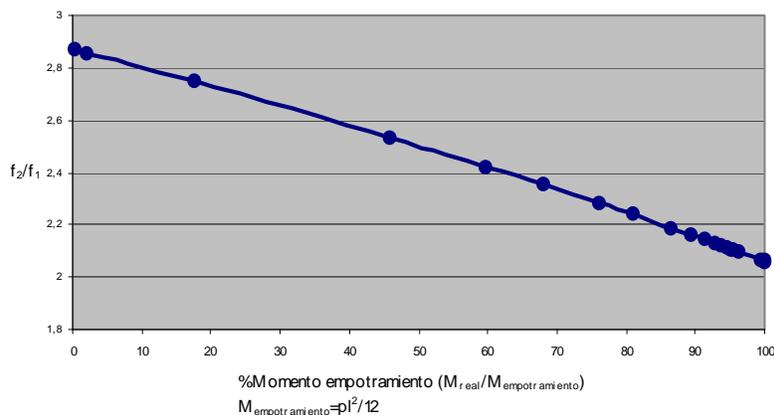
Figura 5: Variación del cociente  $f_2/f_1$  en función del % del Momento de empotramiento teórico para el modelo de viga IPN 280 [elaboración propia].
