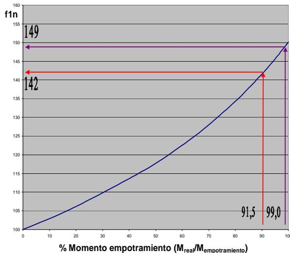
Figura 8: Obtención del valor de la 1ª frecuencia propia normalizadas a partir del % del Momento de empotramiento. [elaboración propia]
