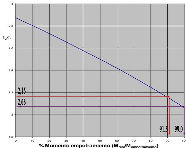
Figura 7: Obtención del % del Momento de empotramiento a partir del cociente  $f_2/f_1$ . [elaboración propia]
