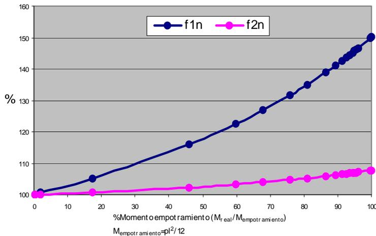
Figura 6: Variación de las frecuencias normalizadas  $f_{2n}$  y  $f_{1n}$  en función del Grado de empotramiento para el modelo de viga IPN 280 [elaboración propia].
